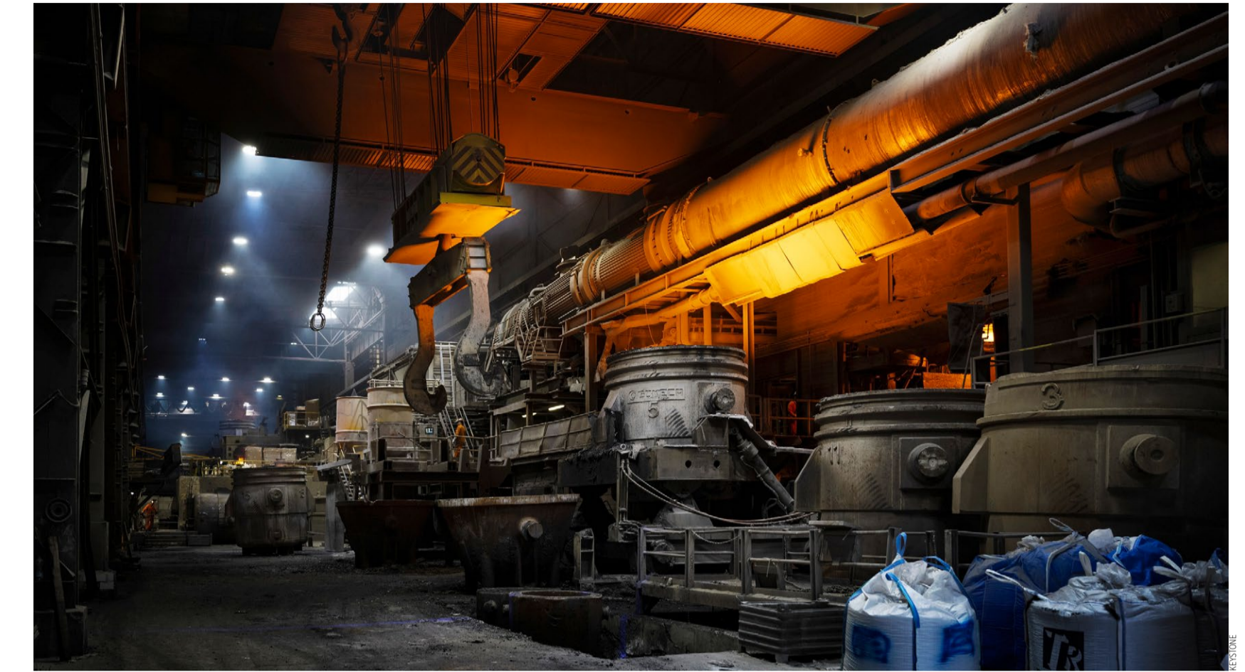
Stahlproduktion Schweiz: Ein mit flüssigem Stahl gefüllter Container neben dem Schmelzofen in der Produktionsstätte der Stahl Gerlafingen AG in Gerlafingen SO.
